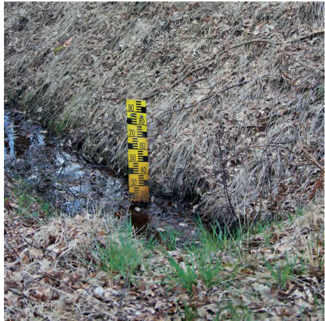
Die Messung der Moorwasserstände ist eine wichtige Grundlage für Wiedervernässungsmaßnahmen. (Foto: Jens Fahning)
